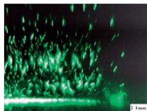
入力信号制御による流れ角制御の例
