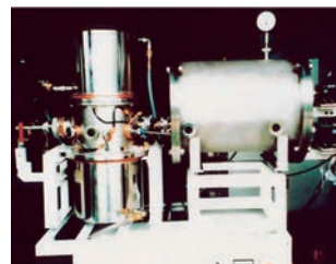
図3 JxB ナノチューブ、微粒子、フラーレン連続合成装置。
