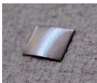
図2 金属基板上に低温コーティング形成された高品質酸化物薄膜
