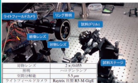
図1 回転工具刃先的高速三次元計測システム
