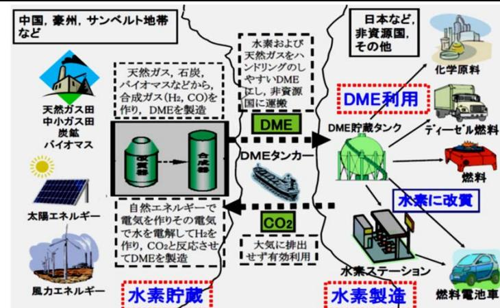
図 低炭素社会に向けてのDMEの流通に関する概念図 (DME-H<sub>2</sub>チェーン)
