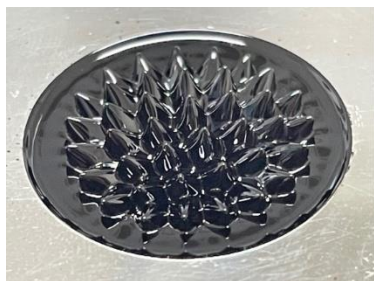
磁場に応答する磁性流体スパイク現象 (撮影: 静岡大学)
