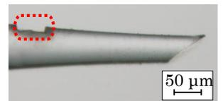
フェムト秒レーザー加工を施した新型光ファイバーセンサー。研究室設備のフェムト秒レーザーを用いて独自開発。
