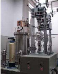
図. 定荷重試験機 (沸騰水型原子炉一次冷却水の環境模擬)
